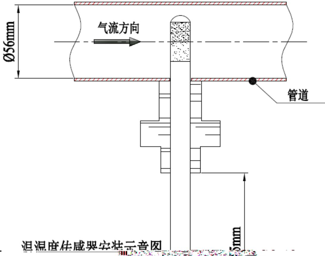
图 2 安装传感器的湿度探头
